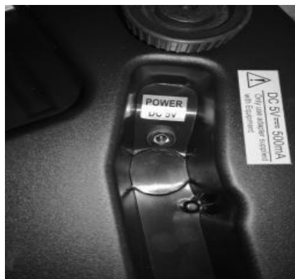
Obr. 2.5 – Pripojenie napájacieho káblu adaptéra S300FM
