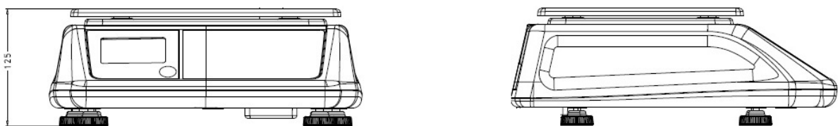
Obr. 3.3 – Rozmery modelu S300LM
